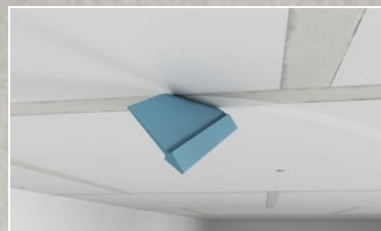
C / Täytä saumat, kiinnitä Rockfon Mono Acoustic Tape ja viimeistele saumat Käytä haluamaasi työkalua sauman täyttämiseen.
